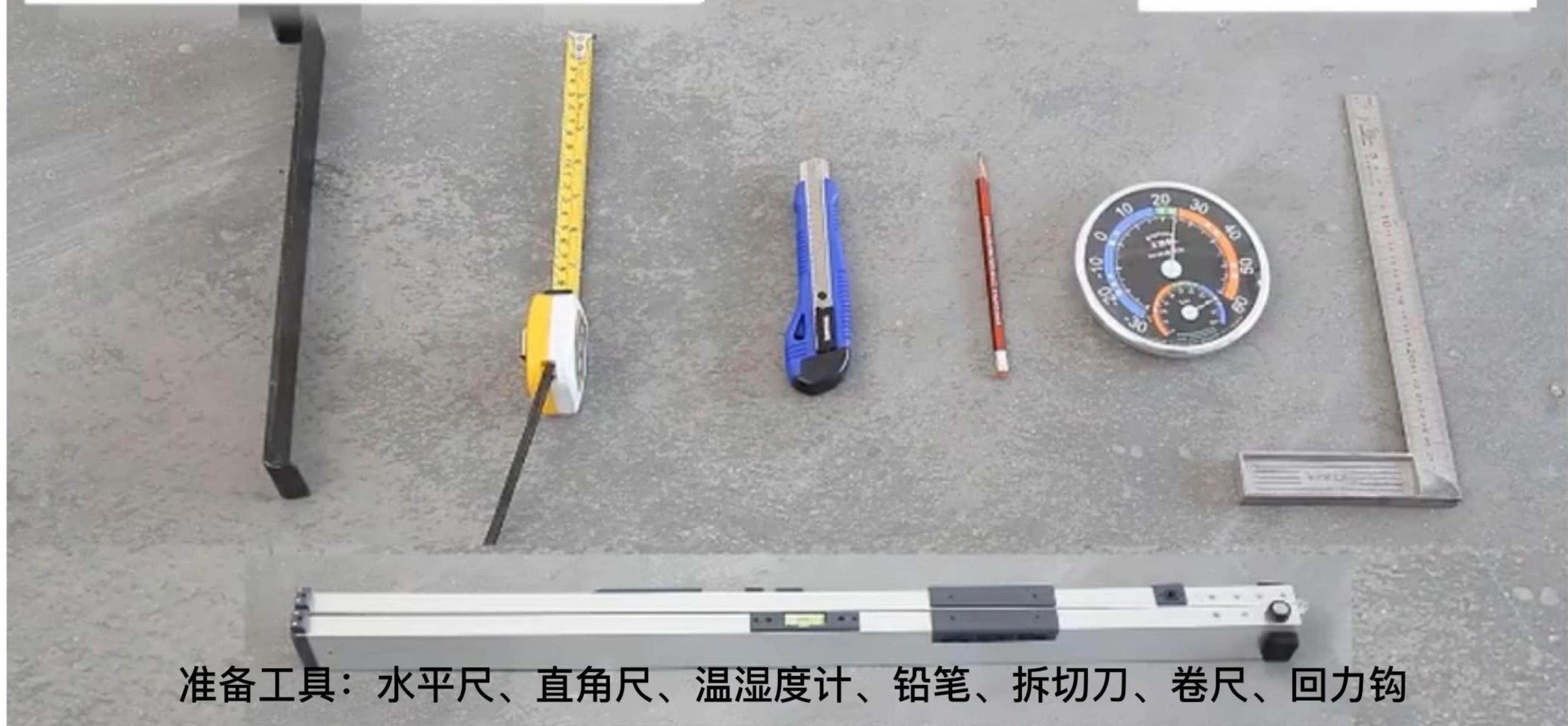
准备工具：水平尺、直角尺、温湿度计、铅笔、拆切刀、卷尺、回力钩
